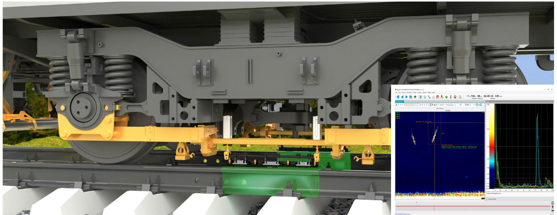
Система подачи контактирующей жидкости обеспечивает бесперебойную подачу воды в том числе с подогревом, для проведения контроля даже в условиях низких температур.
