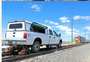
В Бразилии совместно с коллегами из Harsco Rail реализуется проект по созданию комплекса для диагностики геометрии рельсов перед проходом рельсошлифовального поезда и контроля результатов его работы. Этот комплекс создан на базе грузового автомобиля Ford, оборудованного системой комбинированного хода. Ведется также работа по организации поставки и установке нашего оборудования на диагностические поезда в метро Сан-Паулу.
