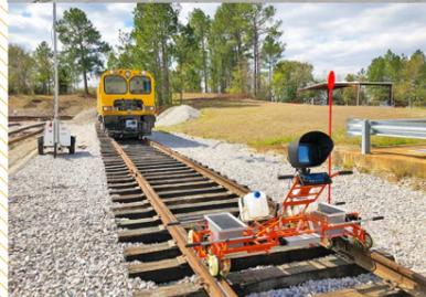
В партнерстве с компанией Harsco Rail для железных дорог США и Канады поставляются диагностические тележки и диагностические системы для установки на автомобили, оборудованные комбинированным ходом. Была также поставлена партия лазерных датчиков для контроля профиля рельсов.
