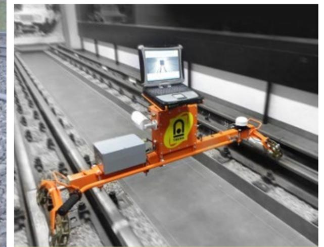
Для расшифровки и регистрации показаний датчиковой аппаратуры комплекса используется блок цифровой обработки сигналов. Во время работы блок подключается к планшетному или переносному компьютеру. Его работу обеспечивает аккумуляторная батарея.
