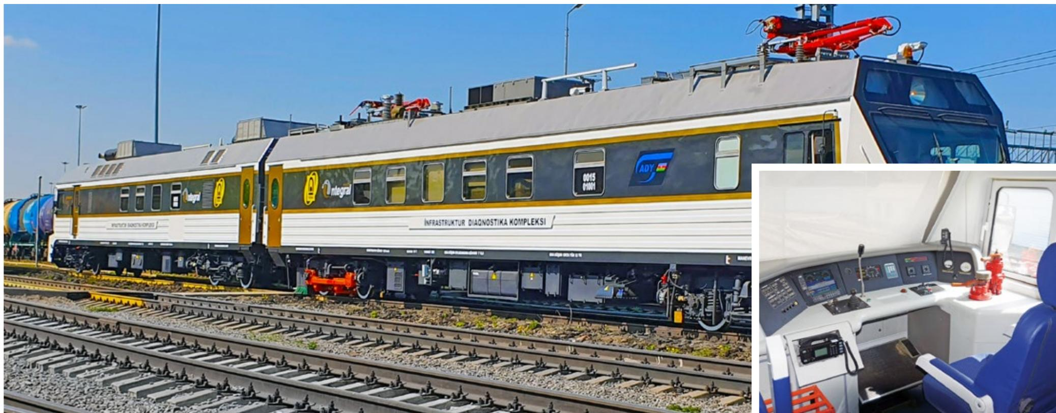
редвижение по железной дороге со скоростью до 120 км/ч, а также электропитание оборудования, технологического инструмента и собственных нужд автотрисы.
