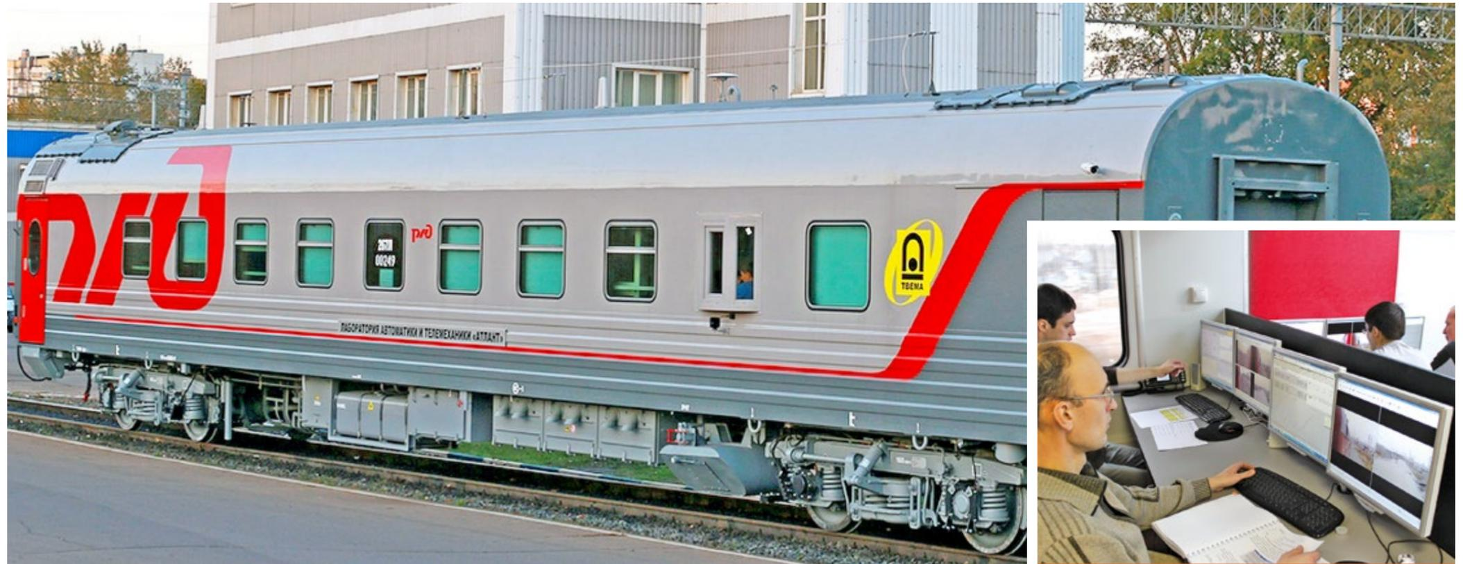
Такой комплексный мониторинг технического состояния устройств ЖАТ и средств поездной радиосвязи позволяет сопоставлять информацию об их фактическом состоянии с данными из базы данных участка дороги, проводить автоматическое сравнение и формировать отчеты и рекомендации эксплуатирующим подразделениям железных дорог по своевременному устранению выявленных нарушений. Лаборатория может эксплуатироваться как с отдельным локомотивом, так и в составе пассажирских поездов.
